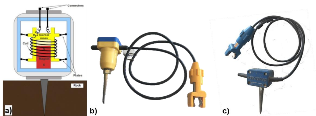
Figura 4 – Geofoni per onda P ed Sh; a) schema di funzionamento del geofono per onda P; b) geofono per onda P con frequenza caratteristica di 4.5 Hz; c) geofono per onda S con frequenza caratteristica di 8 Hz.
